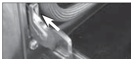
Fig. 6b Clip de retenue de charnière en position verrouillée
