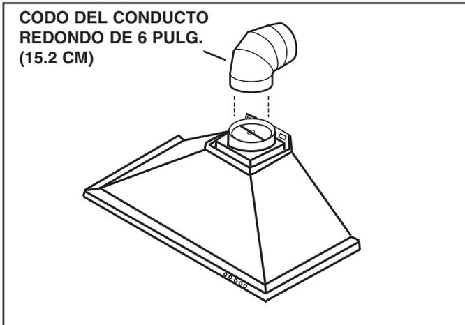
10. Mida e instale los conductos redondos de acero de 6 pulg. (15.2 cm) a la tapa para techo o a la tapa para pared, y el codo de 90° sobre el collarín del tubo en la campana. Use cinta para conductos para fijar y sellar todas las uniones.
