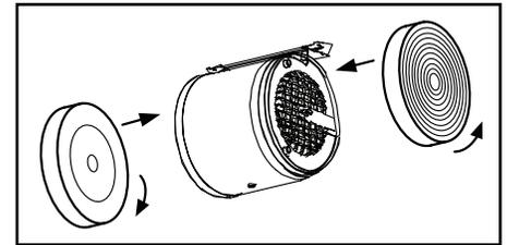
Pour remplacer les filtres de recirculation - veuillez acheter les filtres S97018030 ou FILTRES RONDS.
