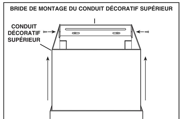
19. Glissez le conduit décoratif supérieur vers le haut jusqu'à ce qu'il soit aligné avec sa bride de montage. La bride doit être à l'intérieur du conduit décoratif. Fixez le conduit supérieur à la bride supérieure avec deux (2) vis de n° 8 x 3/8 po.
