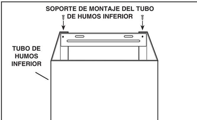
**NOTA: Los cielos rasos de 10 pies (3 m) requieren una extensión del tubo de humos de 10 pies (3 m), modelo FXN58SS para instalaciones con conductos o sin conductos (se compra por separado). Deseche el tubo de humos superior incluido con la campana y reemplácelo con la extensión del tubo modelo FXN58SS.**
