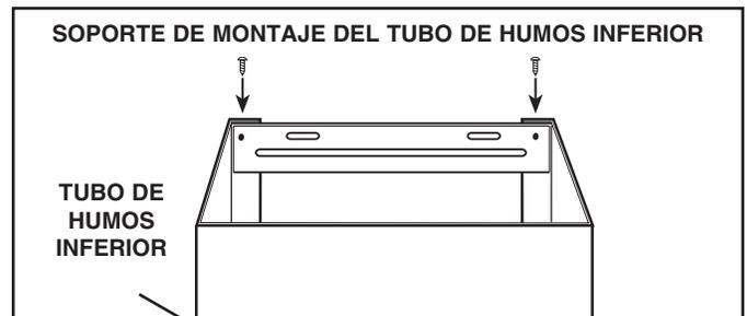
**NOTA: Los cielos rasos de 10 pies (3 m) requieren una extensión del tubo de humos de 10 pies (3 m), modelo FXN58SS (se compra por separado). Deseche el tubo de humos superior incluido con la campana y reemplácelo con la extensión del tubo modelo FXN58SS.**
