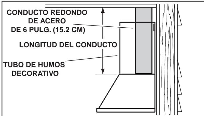
8. Mida e instale los conductos de acero al conector de conductos de la campana. Use cinta para conductos para fijar y sellar todas las uniones.
