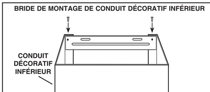
11. Enlevez la section supérieure de conduit décoratif qui se trouve à l'intérieur du conduit inférieur. Fixez la bride sur le conduit décoratif inférieur à l'aide de (2) vis n° 8 x 3/8 po en vous assurant que les fentes sont en haut. Glissez soigneusement le conduit décoratif supérieur à l'intérieur du conduit décoratif inférieur. Enlevez uniquement la pellicule protectrice en plastique recouvrant le conduit décoratif inférieur.
