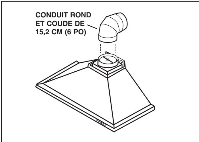
10. Mesurez et installez un conduit rond de 15,2 cm (6 po) jusqu'au capuchon de toit ou capuchon mural et un coude de 90° sur le raccord de conduit de la hotte. Utilisez du ruban pour conduit afin de fixer solidement tous les joints et les étancher.
