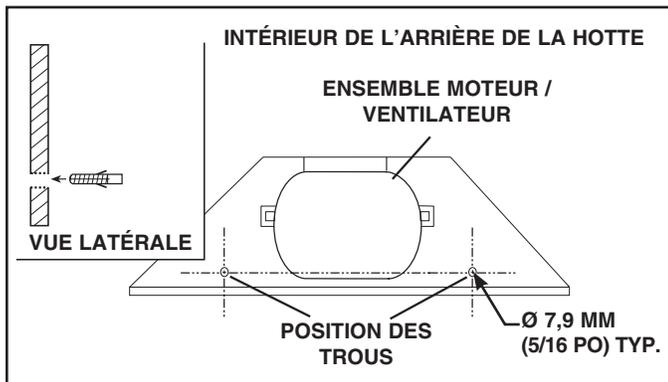
12. La hotte étant suspendue en place, percez à travers les deux trous situés à l'intérieur de l'arrière du boîtier de la hotte à l'aide d'une mèche de 7,9 mm (5/16 po). Insérez les chevilles d'ancrage dans les trous percés (une dans chaque trou). Installez (2) rondelles et (2) vis n° 8 x 1 1/2 po à travers l'arrière de la hotte et dans les chevilles d'ancrage. Vérifiez que la hotte est centrée et de niveau. Serrez complètement les vis.
