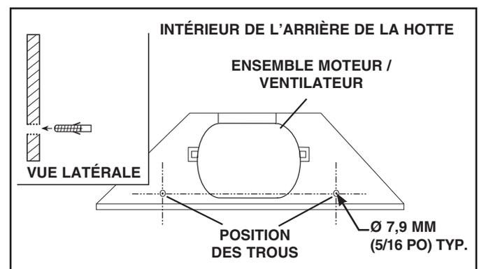
8. La hotte étant suspendue en place, percez à travers les deux trous situés à l'intérieur de l'arrière du boîtier de la hotte à l'aide d'une mèche de 7,9 mm (5/16 po). Insérez les chevilles d'ancrage dans les trous percés (une dans chaque trou). Installez (2) rondelles et (2) vis n° 8 x 1 1/2 po à travers l'arrière de la hotte et dans les chevilles d'ancrage. Vérifiez que la hotte est centrée et de niveau. Serrez complètement les vis.
