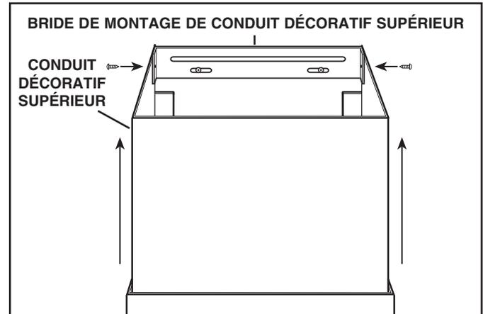
15. Glissez le conduit décoratif supérieur vers le haut jusqu'à ce qu'il soit aligné avec sa bride de montage. La bride doit être à l'intérieur du conduit décoratif. Fixez le conduit supérieur à la bride supérieure avec deux (2) vis de n° 8 x 3/8 po.
