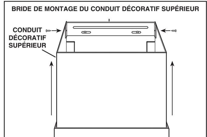
14. Glissez le conduit décoratif supérieur vers le haut jusqu'à ce qu'il soit aligné avec sa bride de montage supérieure. La bride doit être à l'intérieur du conduit décoratif. Fixez le conduit supérieur à la bride supérieure avec deux (2) vis de n° 8 x 3/8 po.
