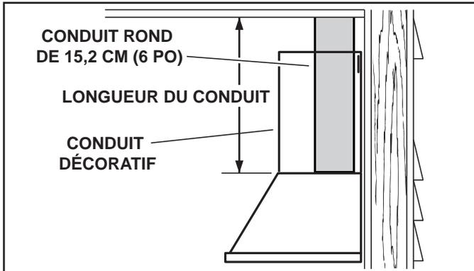
8. Mesurez et fixez le conduit en acier sur le raccord de la hotte. Utilisez du ruban pour conduit afin de fixer solidement tous les joints et les étancher.
