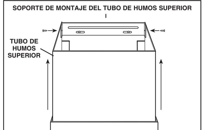
14. Deslice el tubo de humos superior hacia arriba, hasta que quede alineado con su soporte de montaje superior. El soporte debe quedar dentro del tubo de humos. Asegure el tubo superior con el soporte de montaje correspondiente, utilizando dos (2) tornillos de montaje de 8 x 3/8 pulg.
