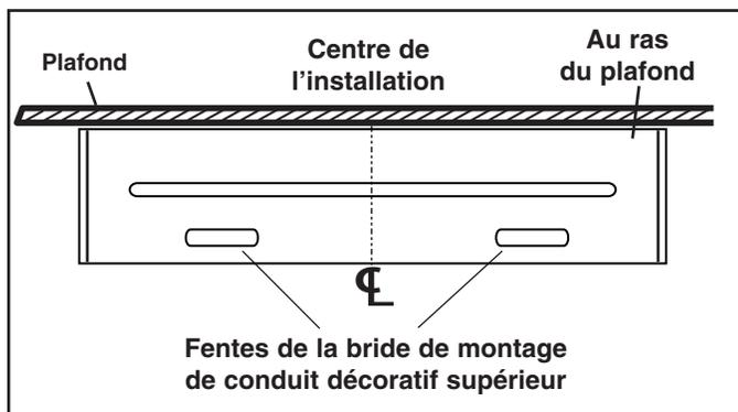
1. Percez deux trous de 7,9 mm (5/16 po) de diamètre aux endroits illustrés. Insérez les chevilles d'ancrage dans les trous.
