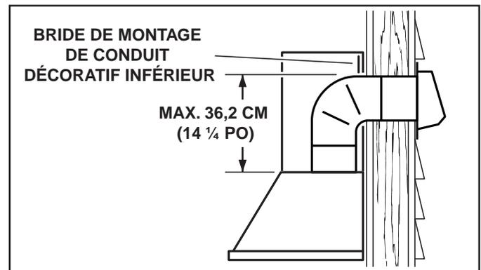
6. Assurez-vous qu'il y a suffisamment d'espace entre le haut de hotte et la bride de montage inférieure pour laisser passer le conduit. Le coude doit être situé en dessous de la bride de montage inférieure.
