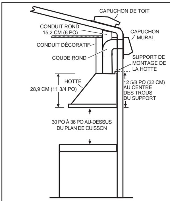
La distance minimale de la hotte au-dessus de la surface de cuisson NE DOIT PAS ÊTRE INFÉRIEURE à 76 cm (30 po). Un maximum de 91,4 cm (36 po) est également fortement recommandé pour mieux capter les vapeurs de cuisson. Une distance de plus de 91,4 cm (36 po) est laissée à la discrétion de l'installateur et des utilisateurs si la hauteur du plafond le permet.
