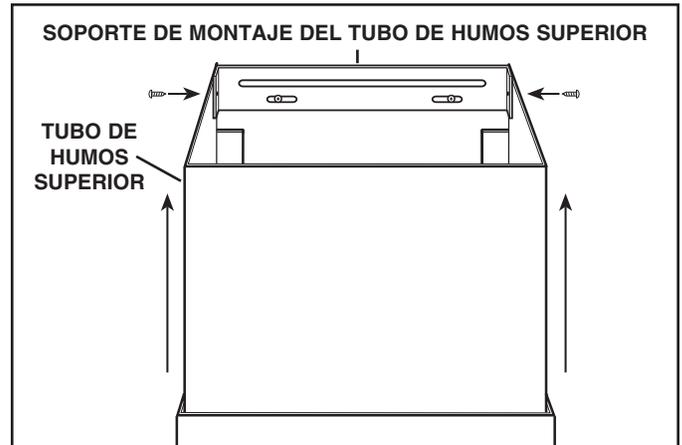
15. Deslice el tubo de humos superior hacia arriba, hasta que quede alineado con su soporte de montaje. El soporte debe quedar dentro del tubo de humos. Asegure el tubo superior con el soporte de montaje correspondiente, utilizando dos (2) tornillos de montaje de 8 x 3/8 pulg.
