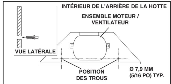
16. La hotte étant suspendue en place, percez à travers les deux trous situés à l'intérieur de l'arrière du boîtier de la hotte à l'aide d'une mèche de 7,9 mm (5/16 po). Insérez les chevilles d'ancrage dans les trous percés (une dans chaque trou). Installez (2) rondelles et (2) vis n° 8 x 1-1/2 po à travers l'arrière de la hotte et dans les chevilles d'ancrage. Vérifiez que la hotte est centrée et de niveau. Serrez complètement les vis.
