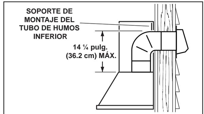
6. Asegúrese de que habrá una separación adecuada entre la parte superior de la campana y el soporte de montaje para los conductos del tubo de humos inferior. El codo debe colocarse debajo del soporte de montaje del tubo de humos inferior.
