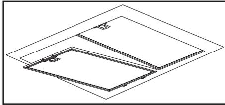
7. Fixez le collier d'installation sans conduits au caisson non canalisé à l'aide de (4) vis ST4 x 8 à tête ronde.
