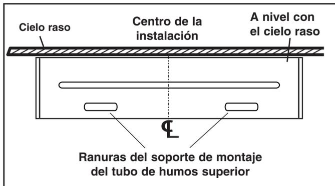
1. Perfore dos orificios de 5/16 pulg. (7.9 mm) de diámetro donde se muestra. Inserte los taquetes para placa de yeso en los orificios.
