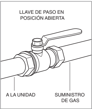
Llave de paso del suministro de gas
