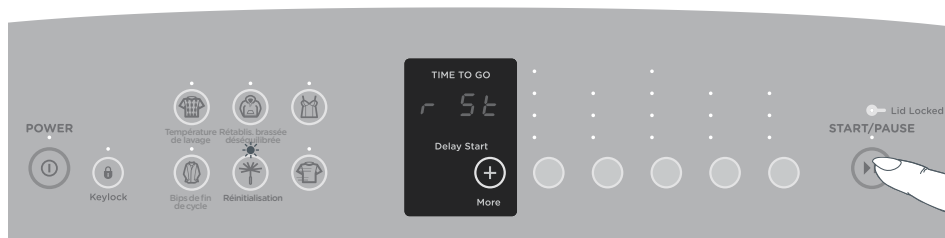
Fig.38 Réinitialisation des réglages de la laveuse aux valeurs par défaut
