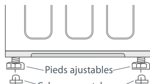
Fig.6 Mise de niveau – Étapes 1 et 2
