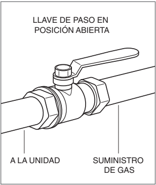
Llave de paso del suministro de gas.
